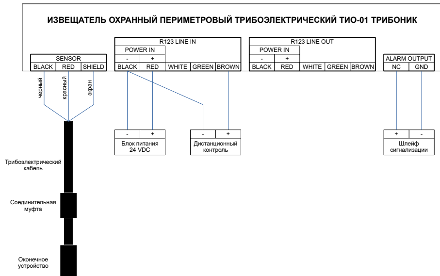
Рисунок 4 – Схема подключения извещателя
